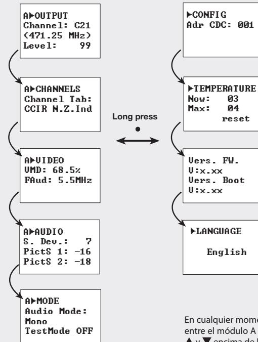
En cualquier momento se puede cambiar entre el módulo A y B pulsando las teclas ▲ y ▼ encima de la indicación A/B en las esquina superior izquierda.
